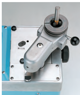
ドリルチャッキング
