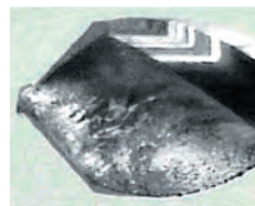
26穴折損時溝凝着大
